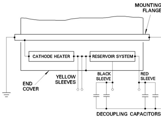
**Fig. 1 CX2593X base connections**
